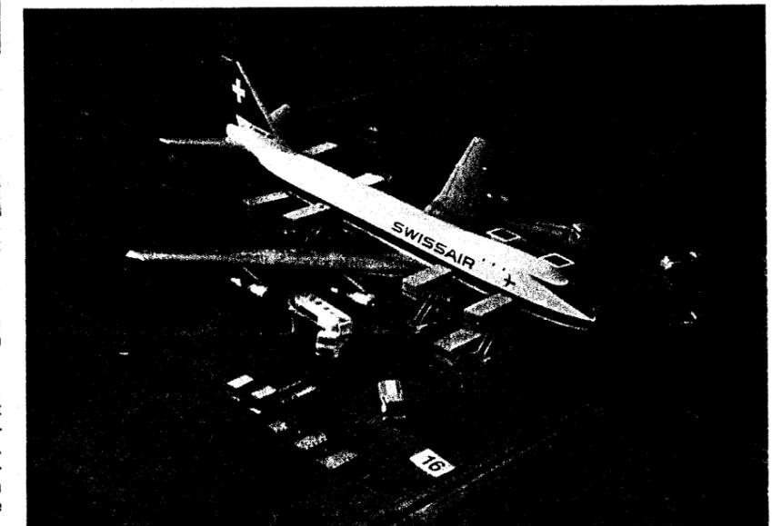
Unsere Bodendienste bemühen sich mit Hilfe von Modellversuchen um die Lösung der komplizierten Abfertigungsprobleme. An der Abfertigung einer einzigen Boeing 747 werden beispielsweise über zwanzig Fahrzeuge beteiligt sein, darunter ein 50 Tonnen schwerer Flugzeugschlepper.
