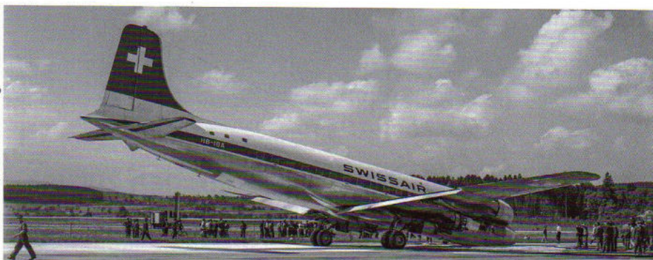
Am 19. Mai 1958 wurde das Fahrwerk der DC-6B HB-IBA während eines Schulfluges beim Durchstarten zu früh eingezogen. Bei der anschliessenden Buglandung wurden die Propeller und Motoren 2, 3 und 4, der Rumpf und das Fahrwerk beschädigt.
