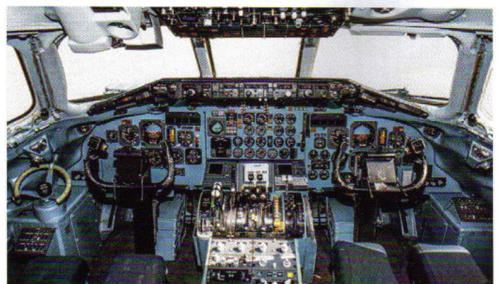
Für den Papstbesuch 1984 rüstete Swissair die DC-9-81 HB-ING mit einer «Suite Papale» um. – Im Cockpit dominierten noch die «Uhreninstrumente», doch fällt auch das elektronische Flight Management System auf.
