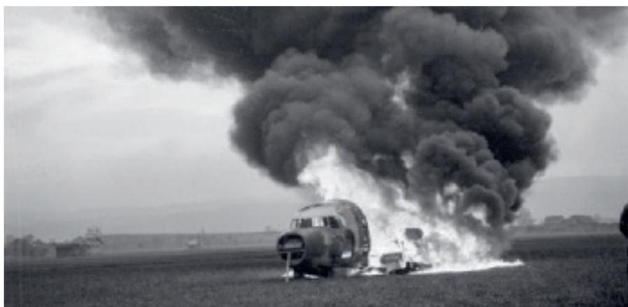
Der ausgeschlachtete Rumpf der HB-IRK wurde am 9. Dezember 1947 zur Erprobung des ersten fahrbaren Gross-Löschgeräts Primus LUKO (LUftschaum-KOhlensäure) in Dübendorf verbrannt.
