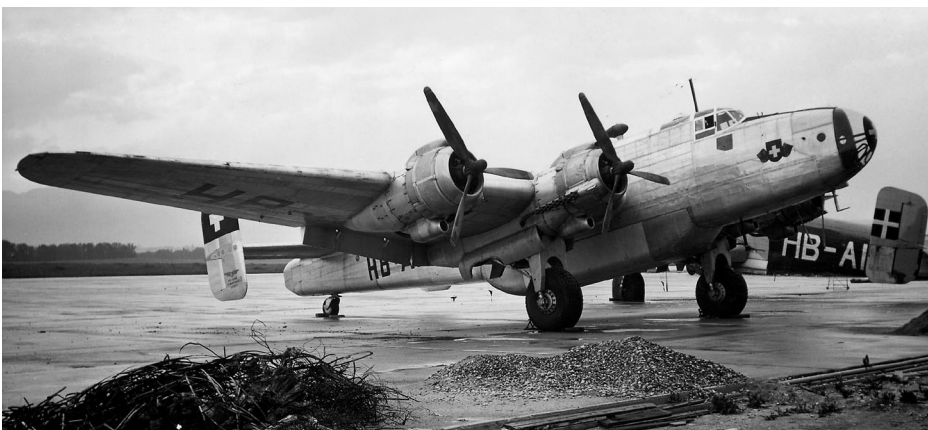
Alleine im Rumpfbehälter konnte die Halton HB-AIF von Air-Globe 3630 Kilo Fracht aufnehmen. Im Krieg war die Halifax für eine Höchstbombenlast von 5900 Kilo zugelassen. Im Hintergrund ist eine zweite Halton von Air-Globe ersichtlich.
