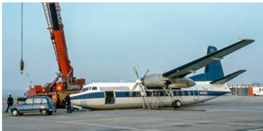
Am 5. November 1984 brach bei der für Crossair eingesetzten WDL Fokker 27 D-BAKU auf dem Vorfeld des Flughafens Basel der rechte Hauptfahrwerksträger.
