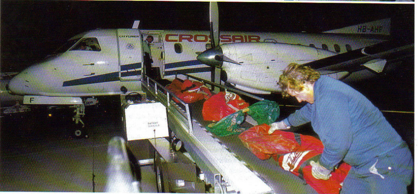
Tags Cityliner, nachts «Päckli-Liner». Zu diesem Zweck werden am Abend Passagiersitze ausgebaut, und der Saab Cityliner verwandelt sich in einen geräumigen Frachter, vollgeladen mit Kleinpaketen und eiligen Dokumenten.
