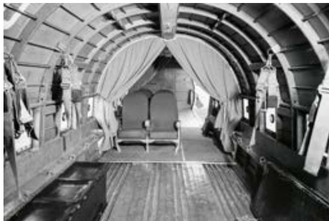
So präsentierte sich die Kabine der DC-3 HB-IRK der Swissair nach dem Umbau für 21 Passagiere und jene der HB-IRX als Frachter.
