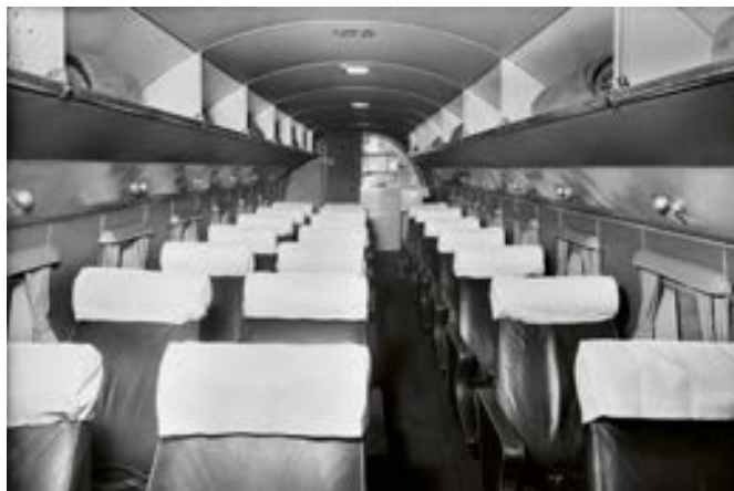
So präsentierte sich die Kabine der DC-3 HB-IRK der Swissair nach dem Umbau für 21 Passagiere und jene der HB-IRX als Frachter.
