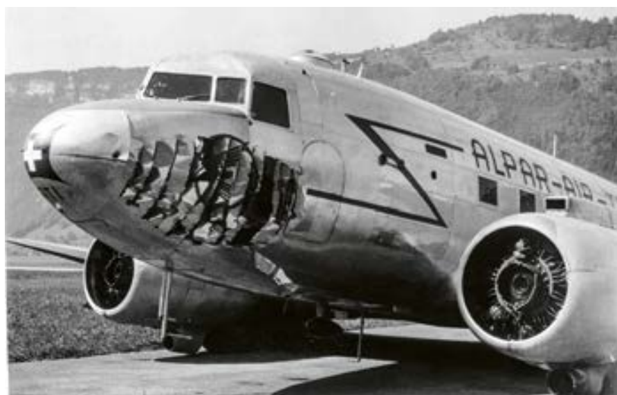
Wegen des vorzeitigen Einziehens des Fahrwerks beim Start in Buochs zum Überflug nach Genf wurde die neu überholte HB-ATI am 25. September 1946 stark beschädigt.
